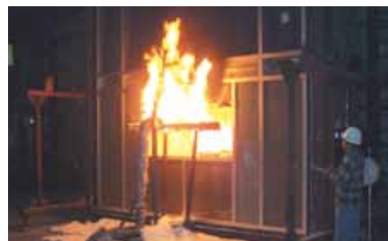
幕墙与楼板边缘的层间防火封墙
